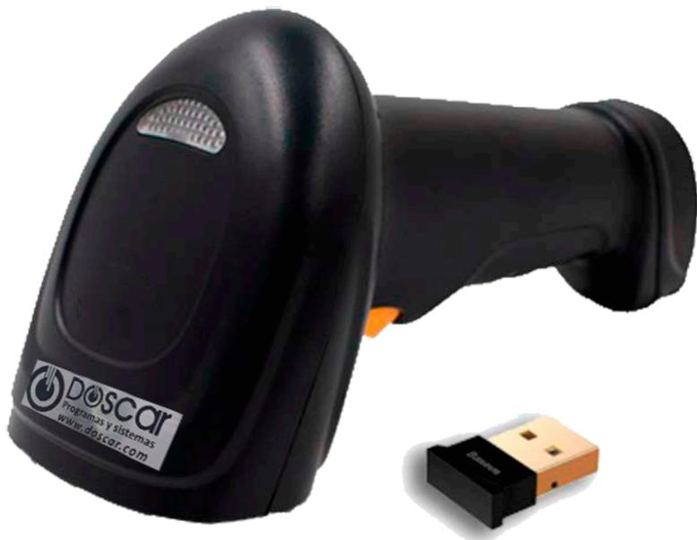
Capacidad: 1D: EAN-8, EAN-13, EAN-13 2 add-on, EAN-13 5 add-on, ISSN, ISBN, UPC-A, UPC-E, Código 39, Código 93, Código 128, Codabar, Industrial 2 de 5, Intercalado 2 de 5, Matrix 2 de 5, GS1-128, GS1 DataBar (RSS14), GS1 DataBar Limited, GS1 DataBar Expanded
